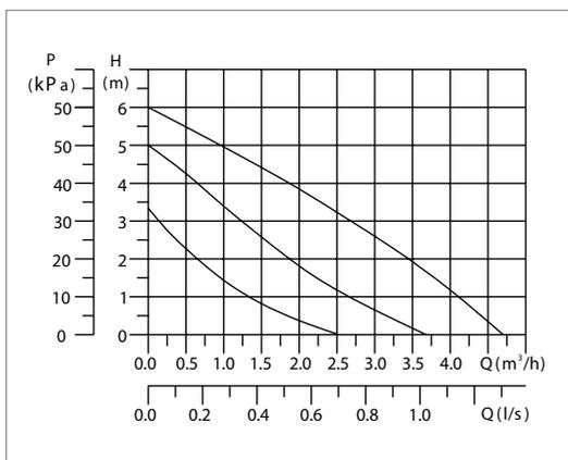
Рис. 2. Рабочее поле для насосов **TL 25-60, TL 32-60** (230 В ~ 50 Гц)
