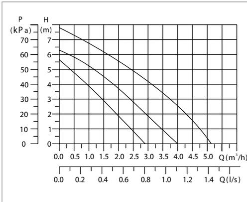
Рис. 3. Рабочее поле для насосов **TL 25-80, TL 32-80** (230 В ~ 50 Гц)
