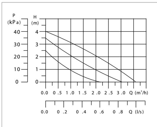
Рис. 1. Рабочее поле для насосов **TL 25-40, TL 32-40** (230 В ~ 50 Гц)
