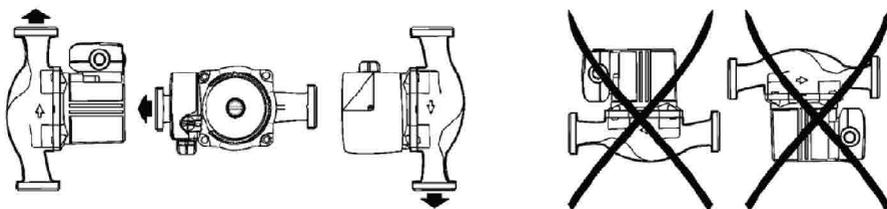
Рис. 3. Положения насоса при монтаже
