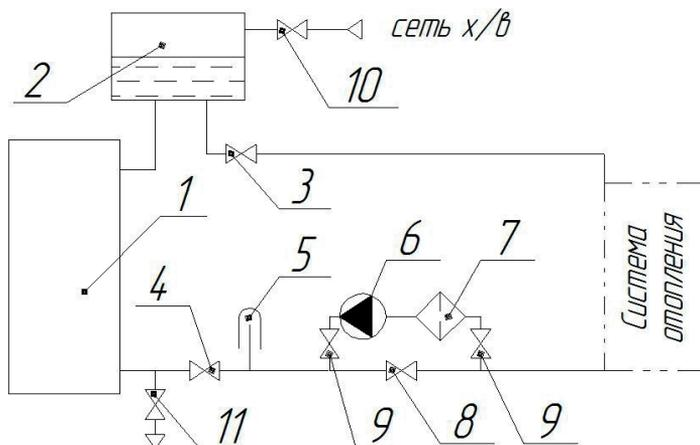
[1] Котел отопительный. [2] Бак расширительный открытого типа. [3] Кран подачи. [4] Кран обратки. [5] Термометр обратки. [6] Насос циркуляционный. [7] Фильтр сетчатый. [8] Кран байпасный или обратный клапан. [9] Краны линии насоса. [10] Кран подпитки системы водой. [11] Кран дренажный.
