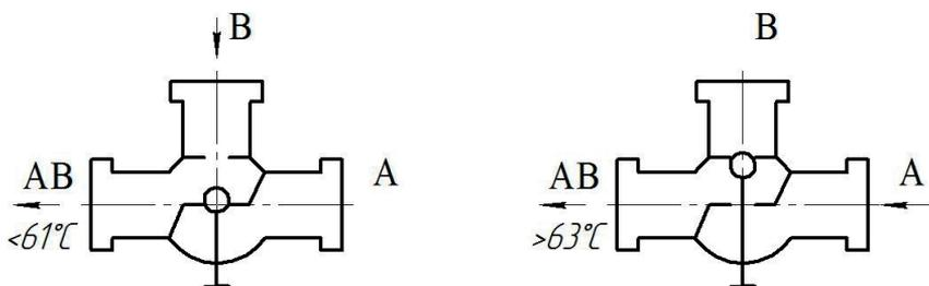
Рисунок 2 — Схема работы клапана с отключаемой подачей теплоносителя из котла.
