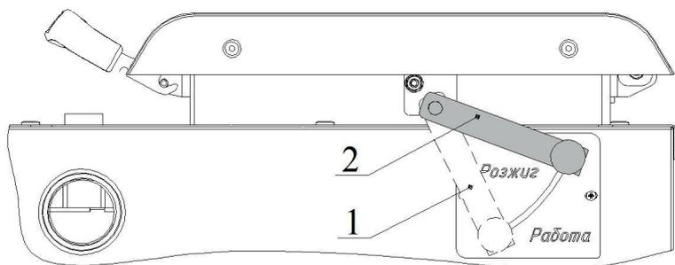
[1] Рычаг заслонки прямого хода дыма в положении «Работа» [2] Рычаг заслонки прямого хода дыма в положении «Розжиг».
