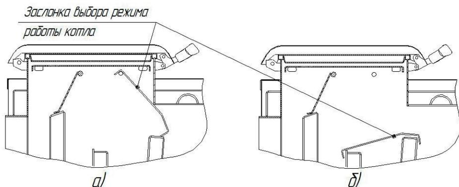
**Рисунок 15 — Положение заслонки выбора режима работы котла**
