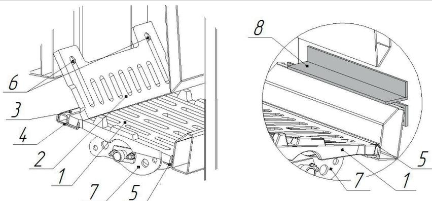
[1] Колосник горизонтальный [2] Колосник наклонный [3] Опора колосника [4] Держатель опоры колосника передней [5] Опора колосника задняя [6] Держатели наклонного колосника [7] Механизм очистки колосника [8] Канал распределения вторичного воздуха.
