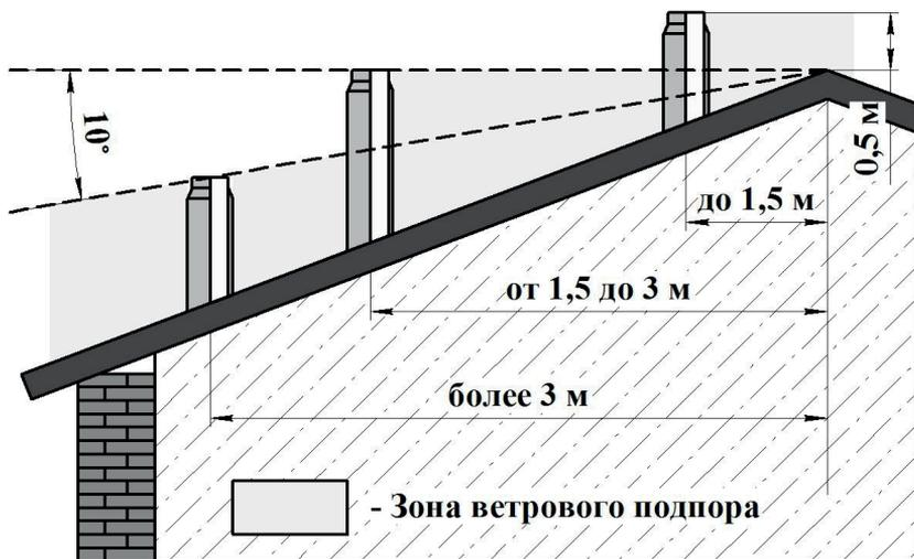
**Рисунок 4 — Требования к высоте дымохода котла**
