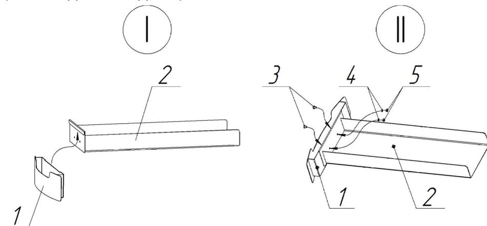
**Рисунок 8 - Схема установки ручки ящика зольника**
