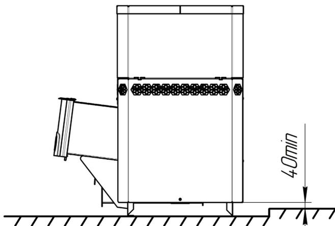
Рисунок 5 — Установка печи ниже уровня чистового пола
