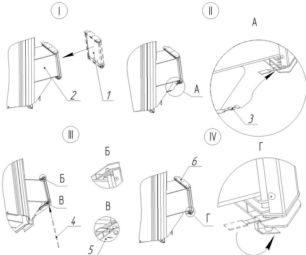
Рисунок 9 - Схема установки ручки ящика зольника
