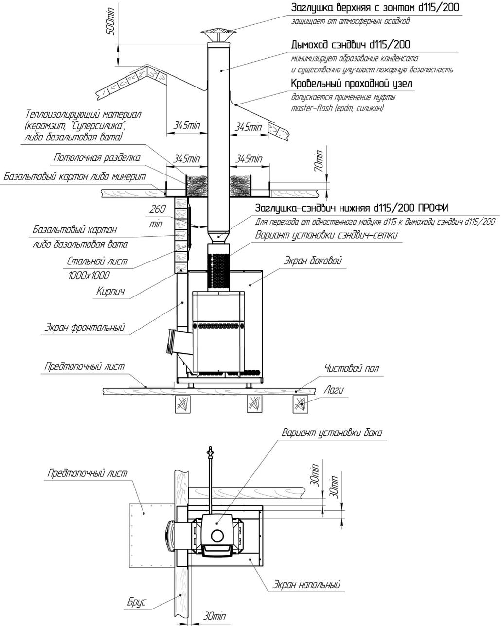
Рисунок 7 - Схема установки печи с защитными экранами
