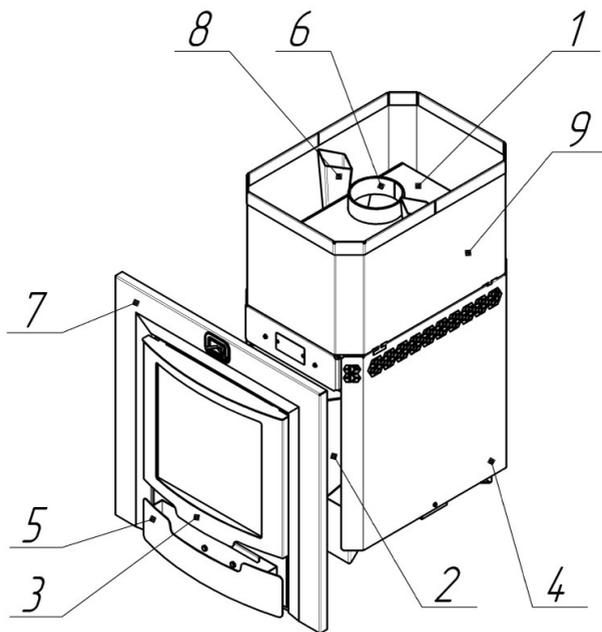
**Рисунок 1в - Конструкция печи-каменки «РУСЬ Панорама 1.1»**
