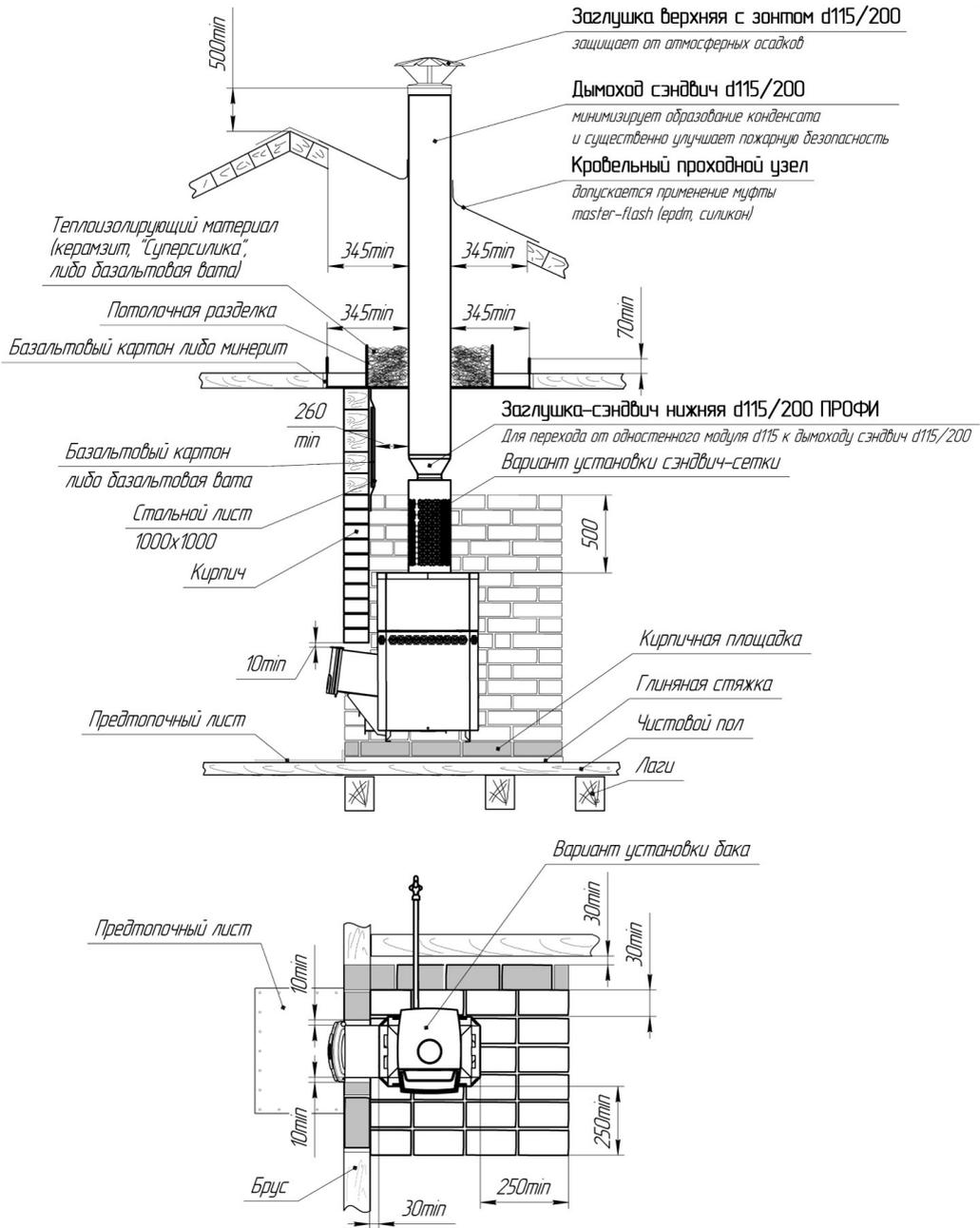
Рисунок 6 - Схема установки печи с кирпичной кладкой
