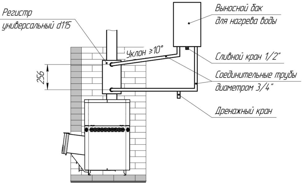
**Рисунок 2 - Подключение бака с универсальным регистром-теплообменником**
