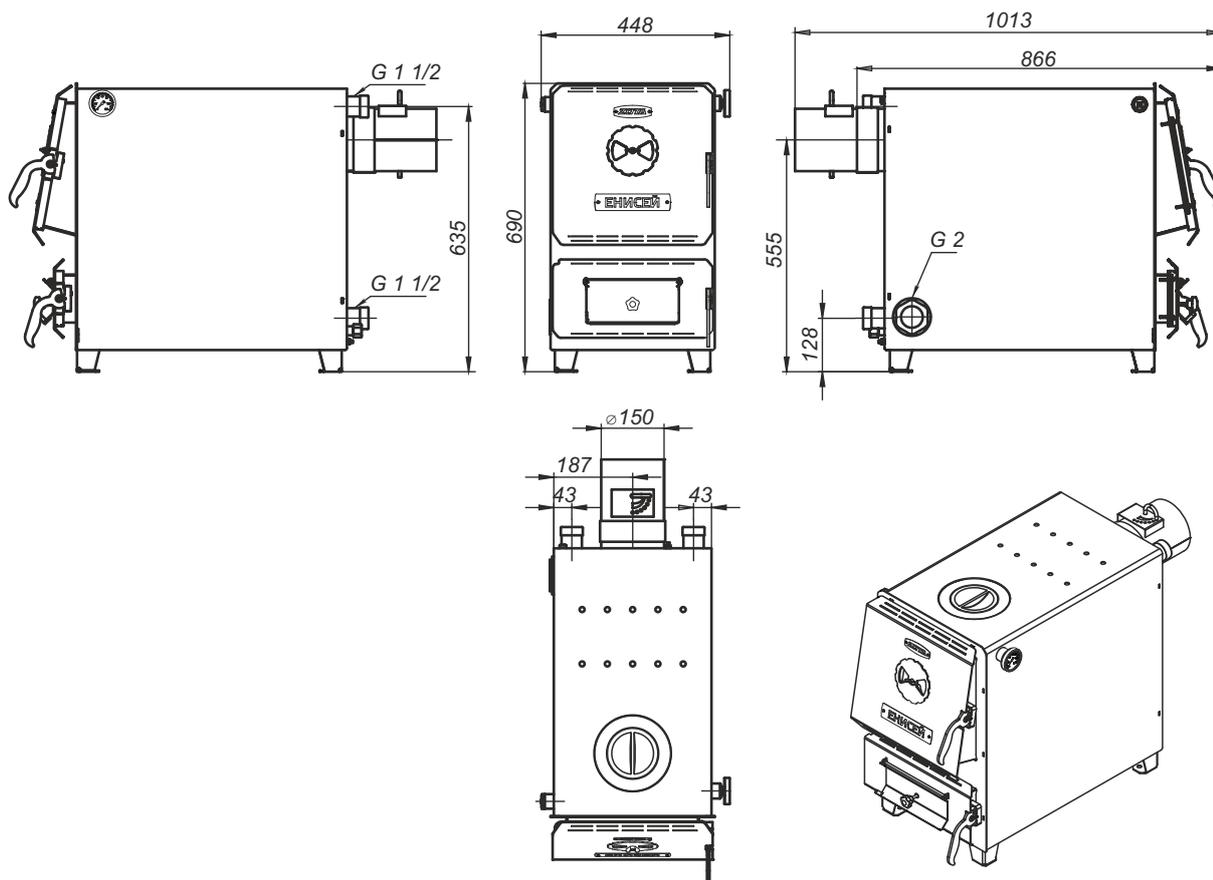
Котлы «Енисей» 14, 20, 25 выполнены без варочной поверхности, их монтажные размеры полностью идентичны размерам котлов мощностью 12, 18, 23 кВт .
