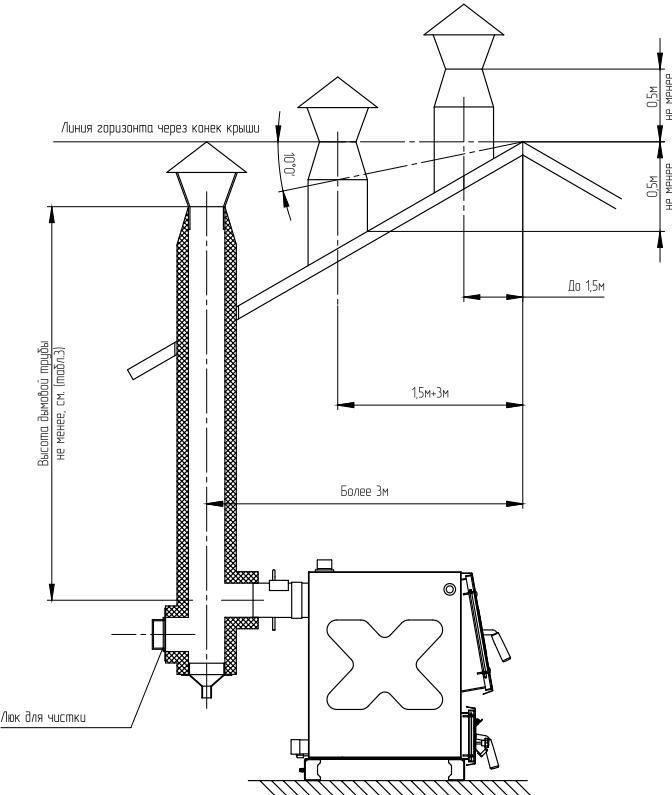
**Рис.3. Варианты установки дымовой трубы.**
