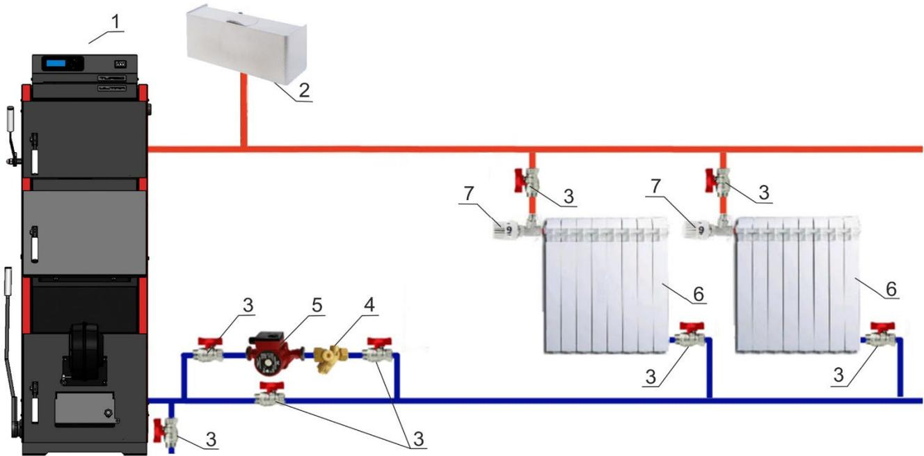
**Рис. 5** Схема подключения котла к открытой системе с принудительной циркуляцией теплоносителя<sup>1</sup>
