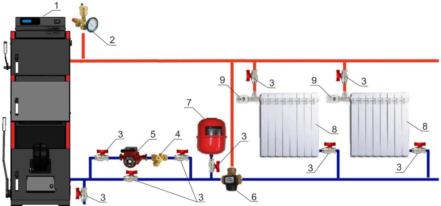
**Рис. 7** Схема подключения котла к закрытой системе с принудительной циркуляцией теплоносителя с термостатическим смесительным клапаном<sup>1</sup>
