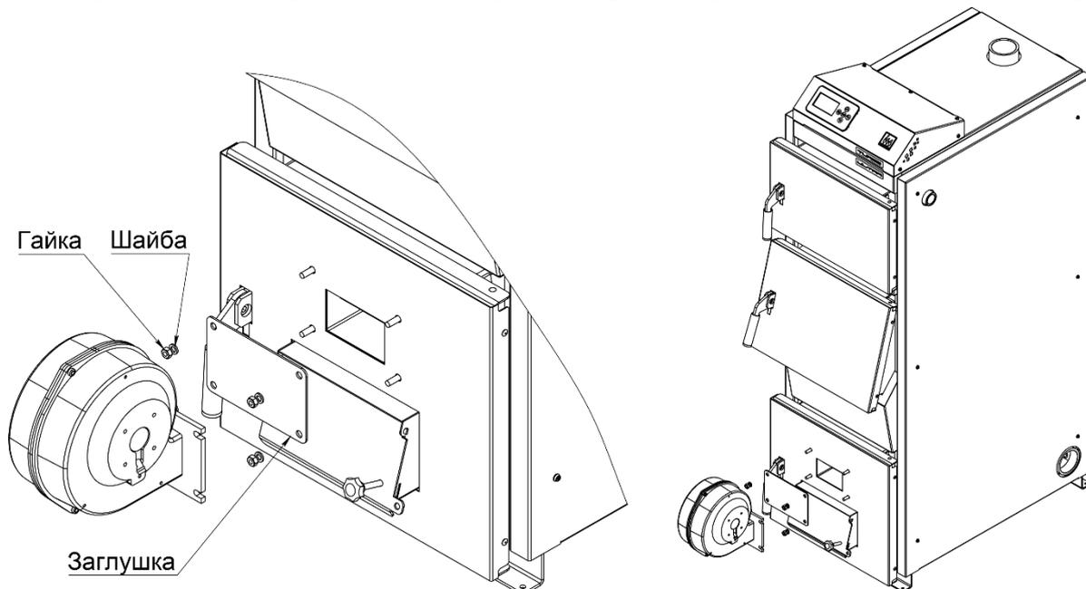
**Рис. 8** Снятие заглушки и установка вентилятора наддува
