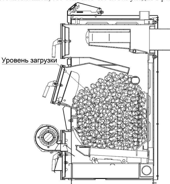
**Загрузку угля производить не выше нижней кромки загрузочной дверцы (рис. 12).**
