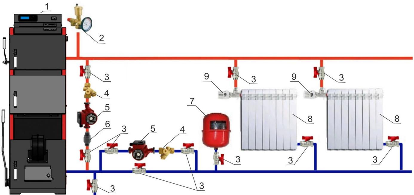
**Рис. 6** Схема подключения котла к закрытой системе с принудительной циркуляцией теплоносителя с рециркуляционным насосом<sup>1</sup>
