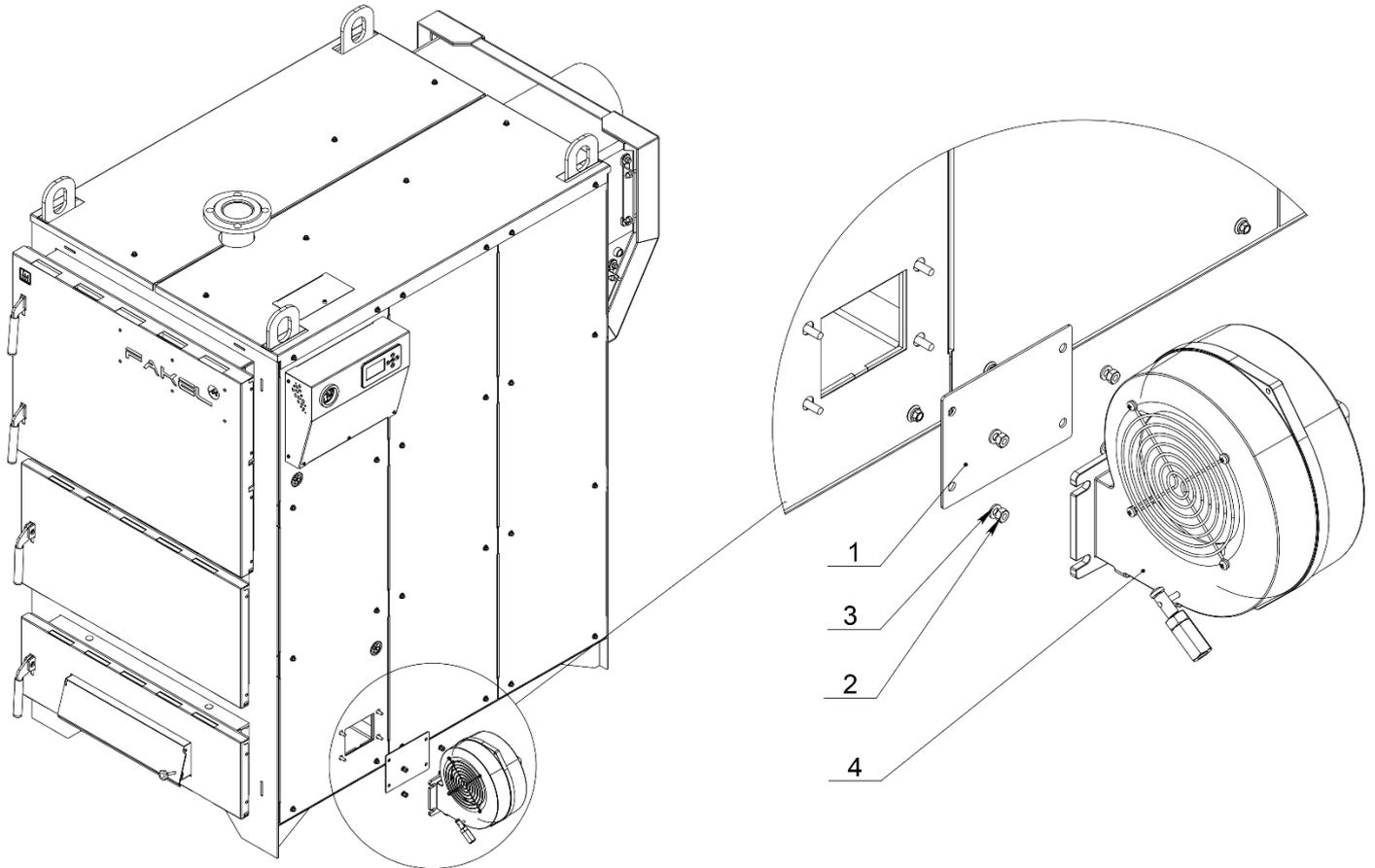
**Рис. 6** Снятие заглушки и установка вентилятора наддува
