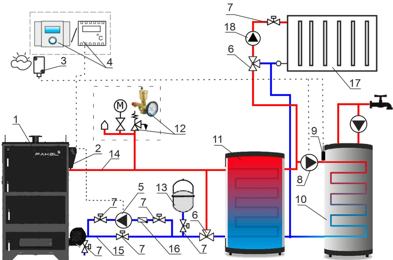
**Рис. 5** Гидравлическая схема подключения <sup>1</sup>
