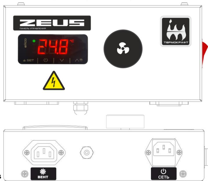
**Рис. 7 Панель управления котла ZEUS-Turbo**
