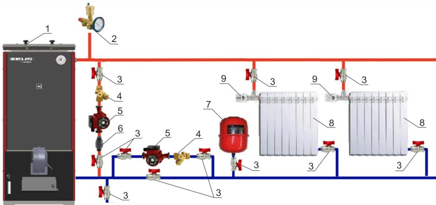
**Рис. 3** Схема подключения котла к закрытой системе с принудительной циркуляцией теплоносителя с рециркуляционным насосом
