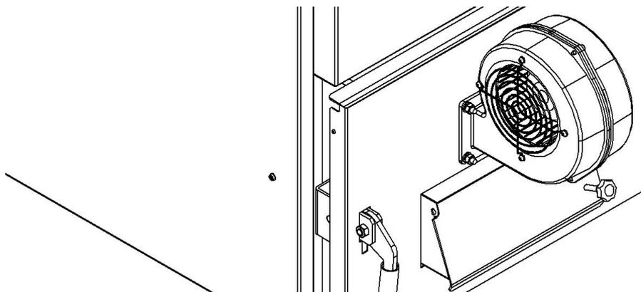
**Рис. 6 Установка вентилятора наддува**
