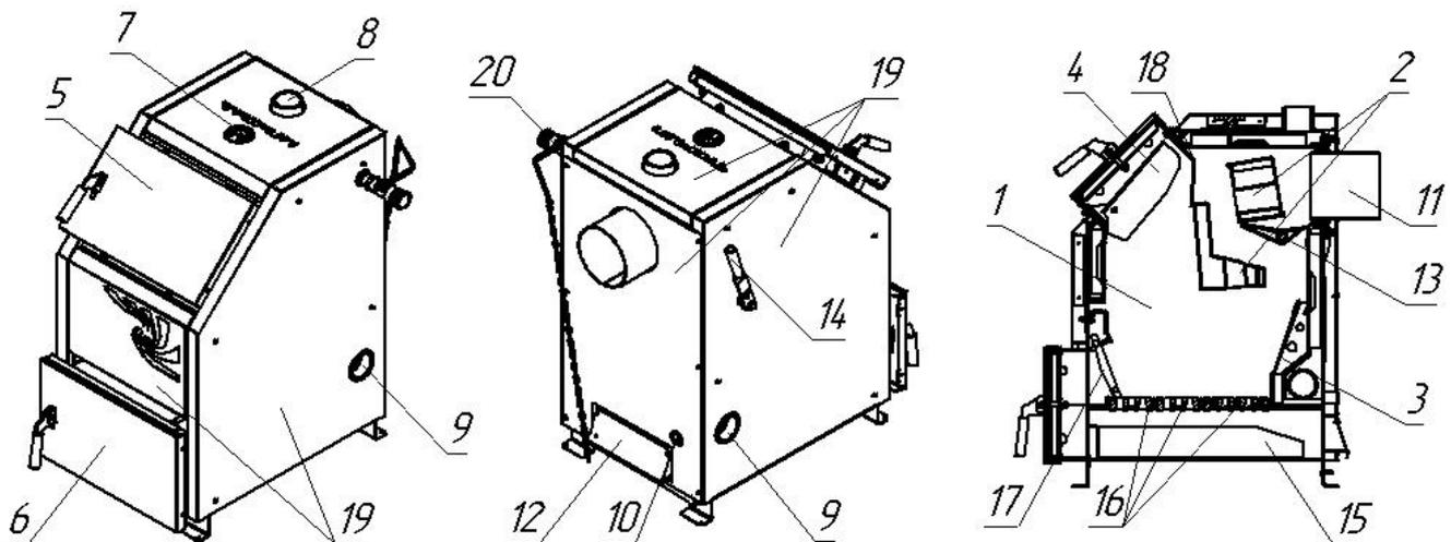
**Рис. 2 Устройство котла ТАIFUN 16кВт**
