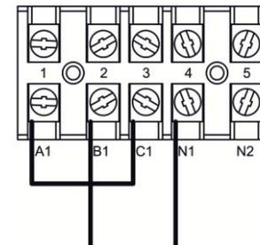
Рисунок 4. Схема однофазного подключения электрокотлов – 3-6кВт.
