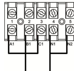
Рисунок 5. Схема однофазного подключения электрокотлов – 7,5-9кВт.
