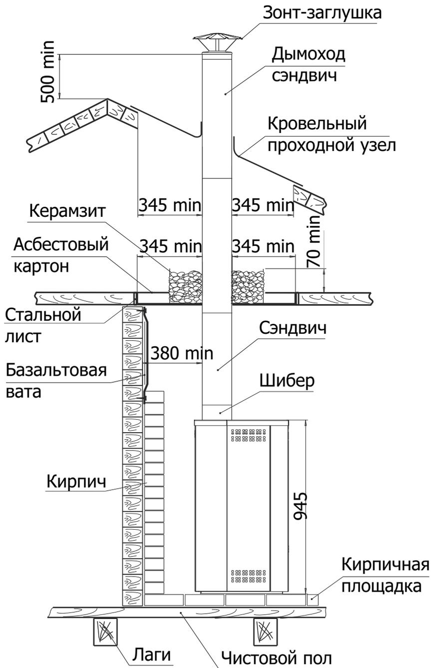
Рис. 2. Схема установки камина и монтаж дымохода
