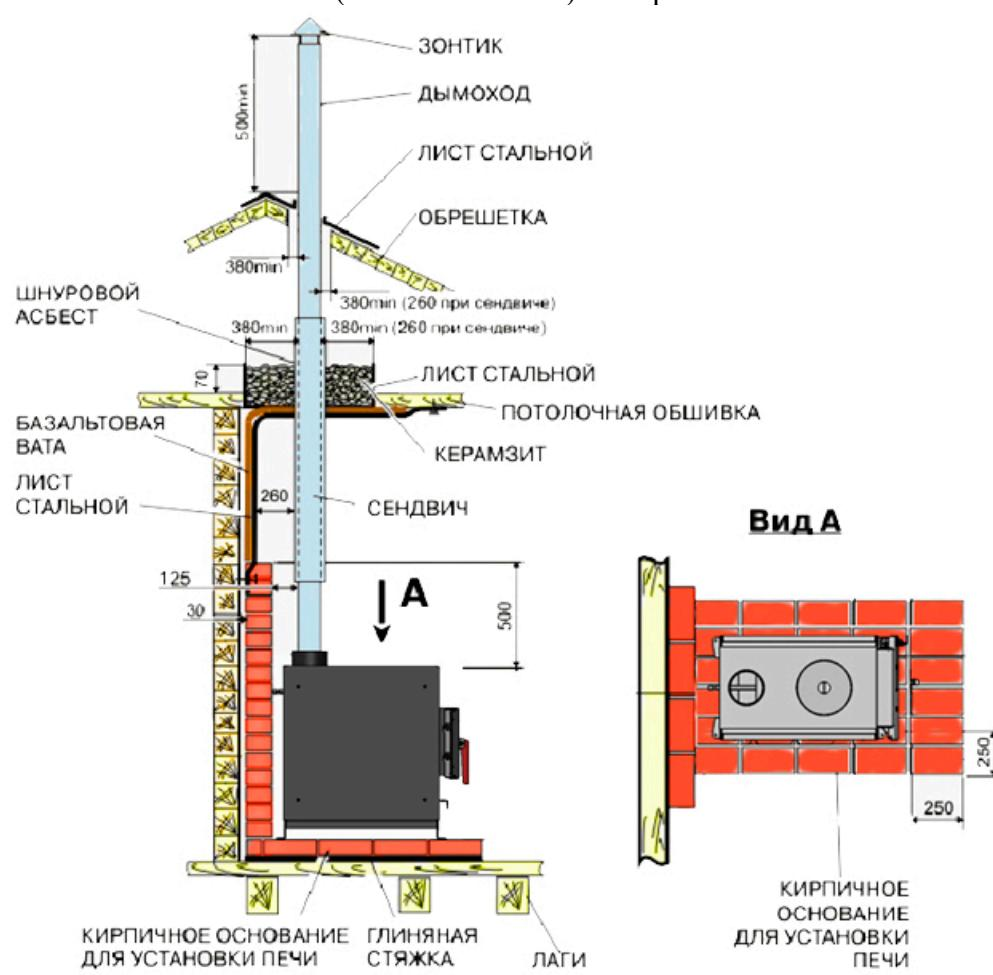
Рис. 3 Монтаж печи MIRA
