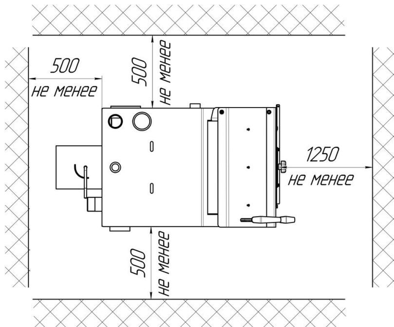
**Рис. 1** Схема установки котла
