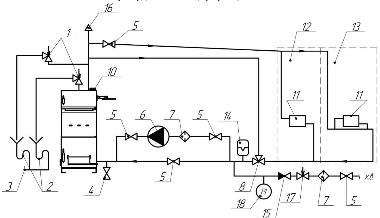
**Рис. 4** Схема подключения котла к закрытой системе отопления с принудительной циркуляцией
