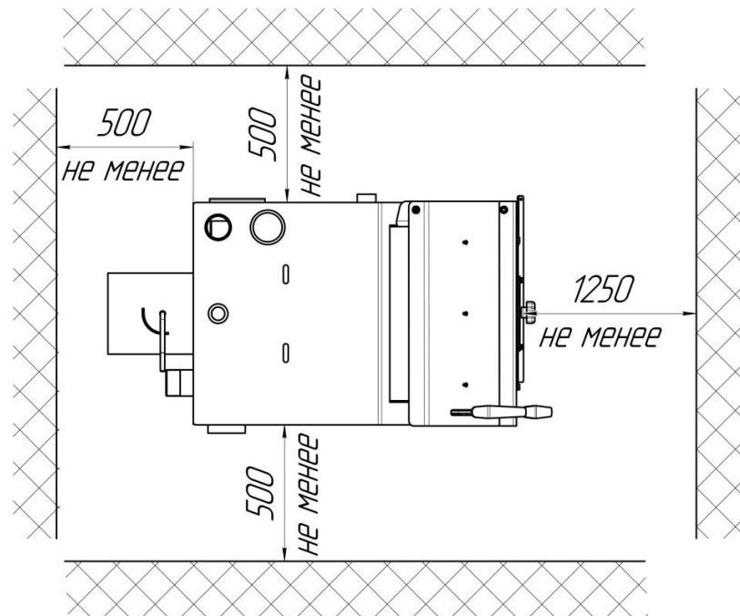
**Рис. 1 Схема установки котла**
